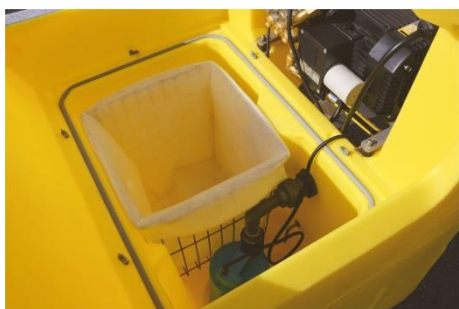
Im Gewebeschmutzfilter werden die Feststoffe aus dem verschmutzten Wasser gefiltert.
