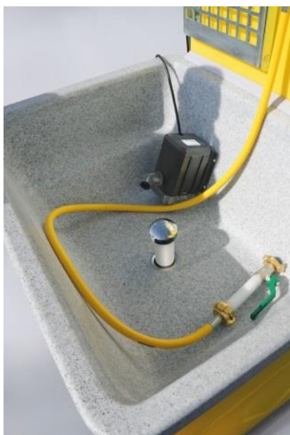
Im Gewebeschmutzfilter werden die Feststoffe aus dem verschmutzten Wasser gefiltert.
